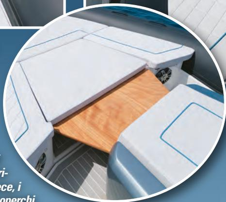
*L'area di prua ha una conformazione a dinette. Sono stati previsti tre gavoni per riporre bagagli e dotazioni più uno destinato al verricello elettrico da 500 W e alla catena. Il prendisole può essere ulteriormente ampliato con due prolunghe in legno. I portelli laterali sono dotati di attuatori, mentre quello centrale si ribalta sui tubolari. Mancano, invece, i profili in gomma sulle battute dei coperchi.*
