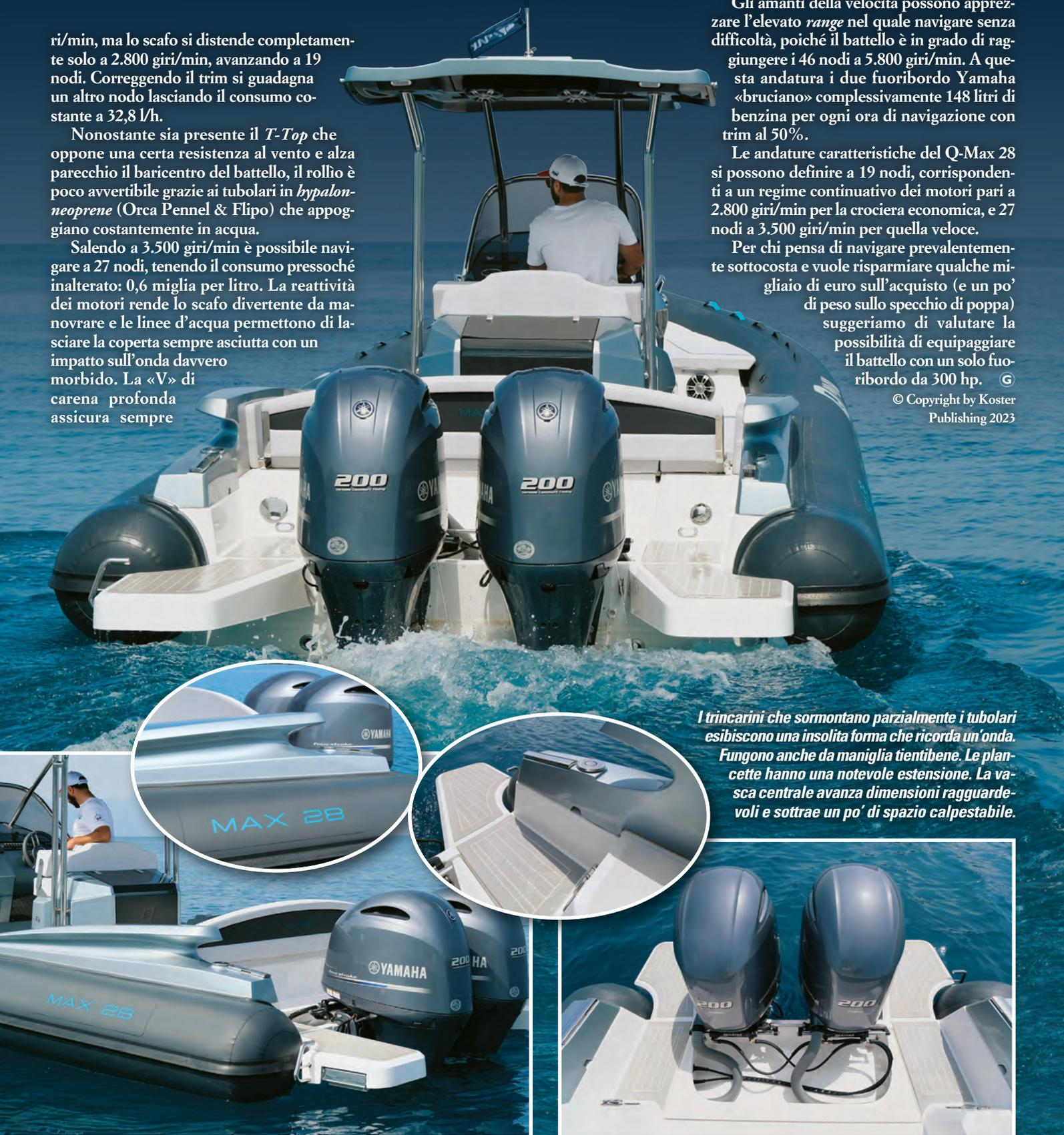
*I trincarini che sormontano parzialmente i tubolari esibiscono una insolita forma che ricorda un'onda. Fungono anche da maniglia tientibene. Le planchette hanno una notevole estensione. La vasca centrale avanza dimensioni ragguardevoli e sottrae un po' di spazio calpestabile.*
